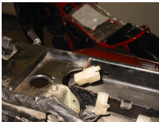
Le connecteur des condensateurs est débranché
